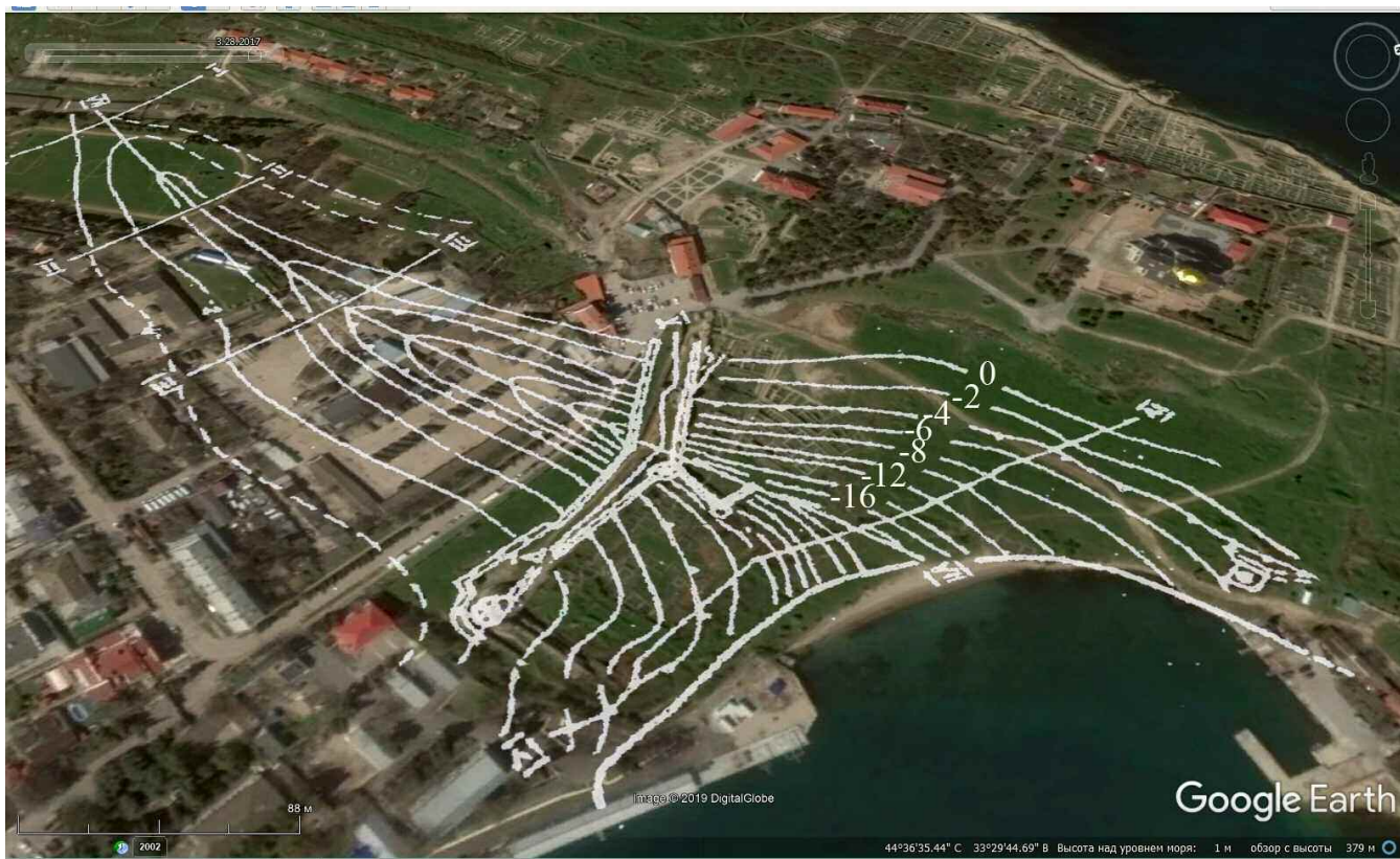
Рис. 9. Вид на Портовый район (GoogleEarth 7.1.2.2041). Наложена геологическая схема погребенной балки (по И.А. Антоновой [1]). Цифры на изолиниях показывают общую толщину осадочных слоев, заполняющих погребенную балку.
